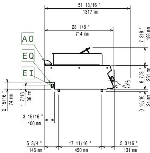
EI = Conexión eléctrica (energía)
